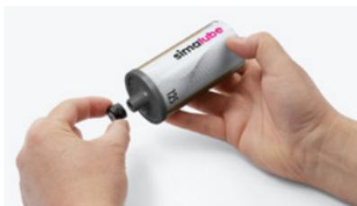
**Bei ölbefüllten Spendern Stopfen nicht entfernen!** Vorstehenden Nippel mit Messer abschneiden, bis ein kleiner schwarzer Punkt sichtbar wird (Öffnung ist nun gewährleistet).
